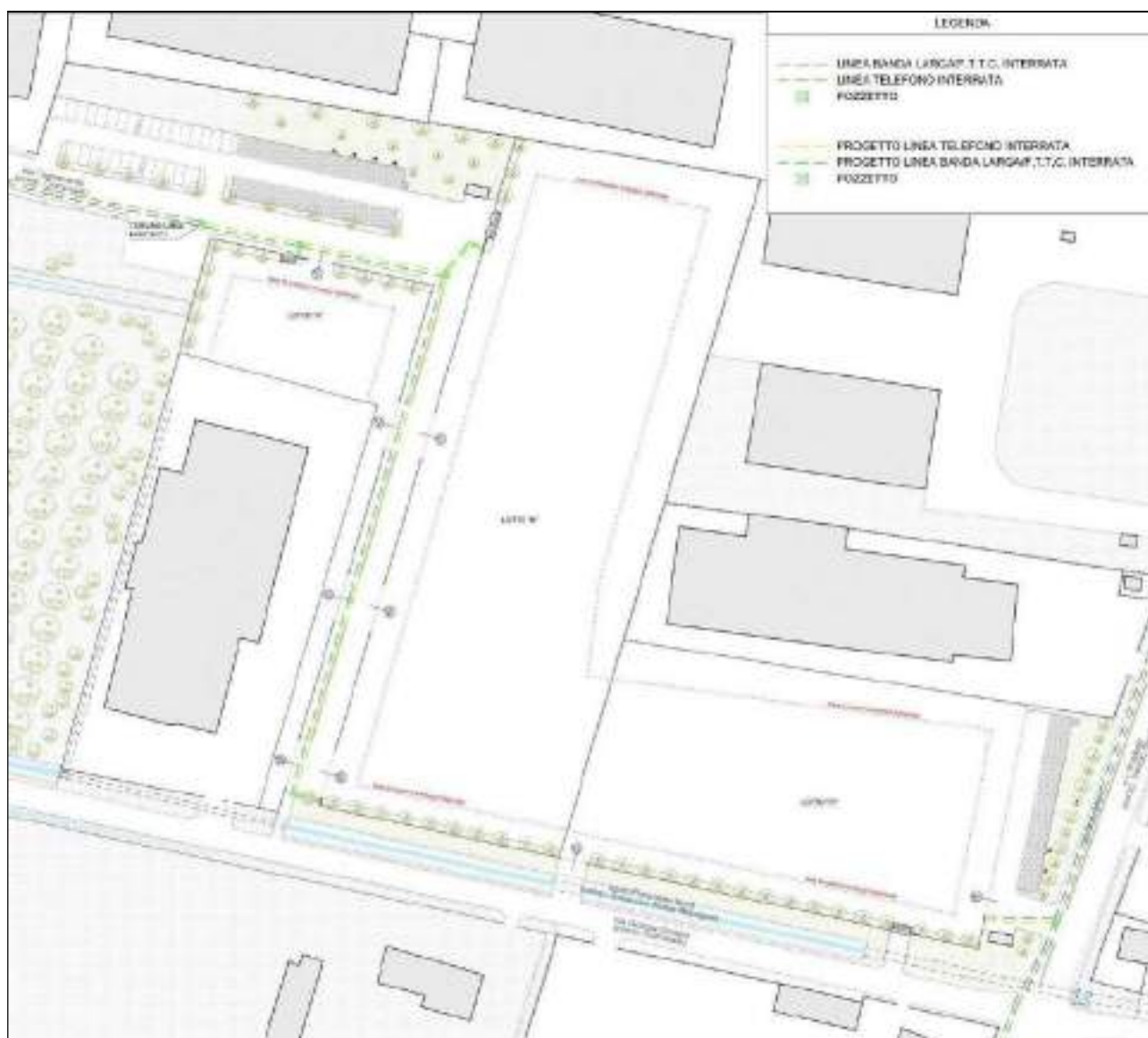
Figura 4/5: Sottoservizi rete telefonica, banda larga, fibra
